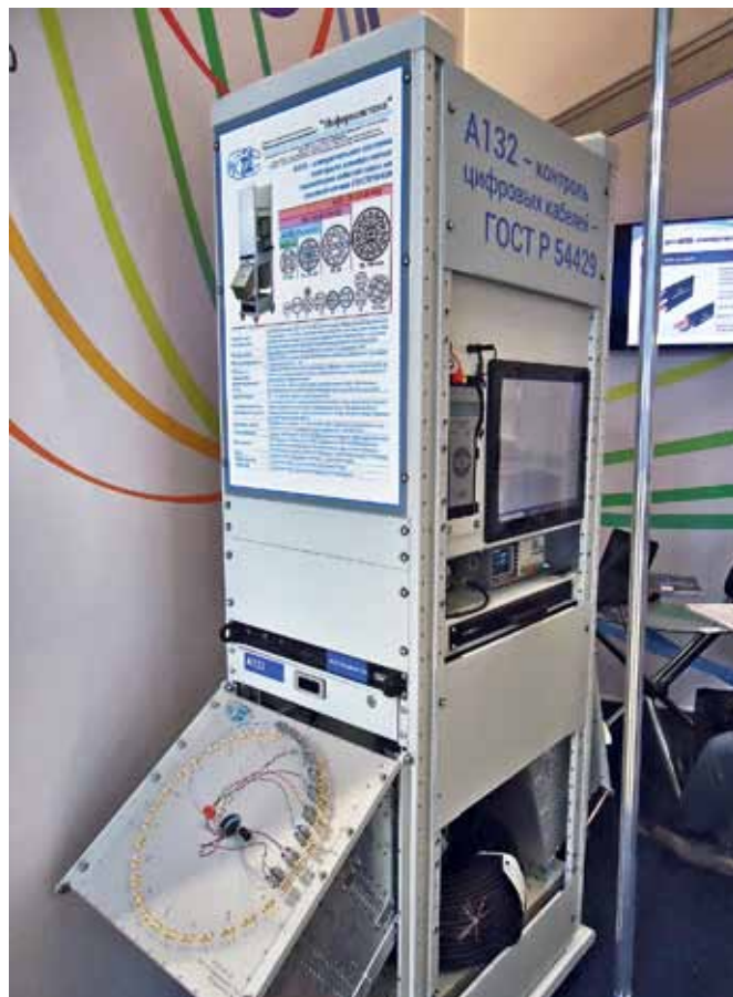
А132 – испытательная установка для контроля электрических параметров кабелей связи
