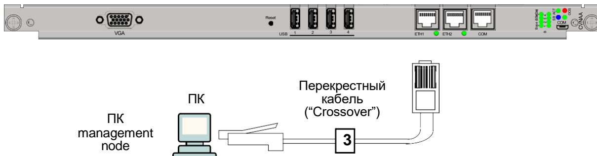
Рисунок 6-10: Подключение ПК к плате CVN через интерфейс Ethernet
