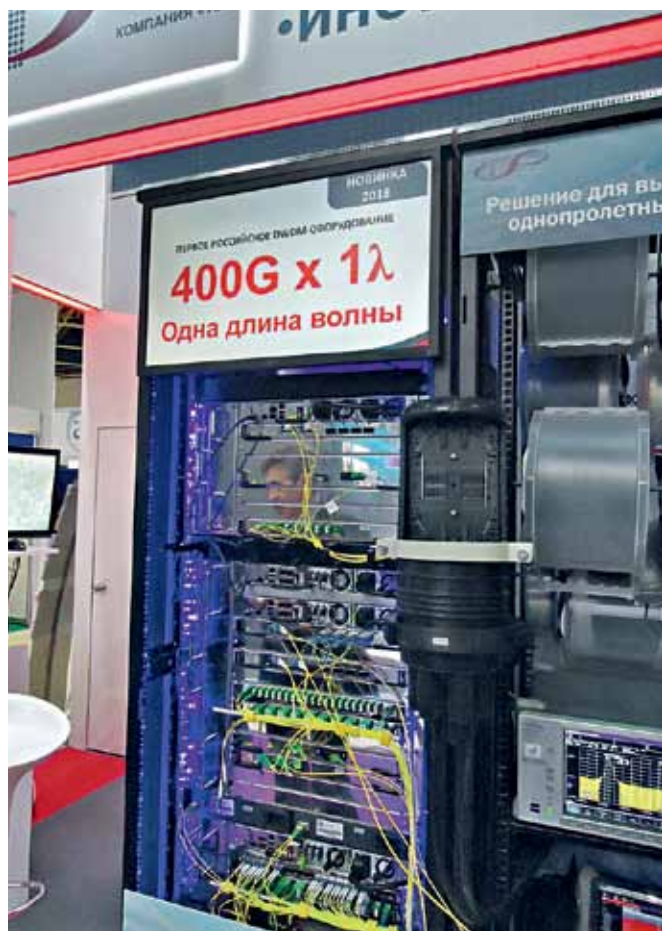
Мультиплексор производства "Т8" обеспечивает передачу на одной несущей со скоростью 400 Гбит/с
