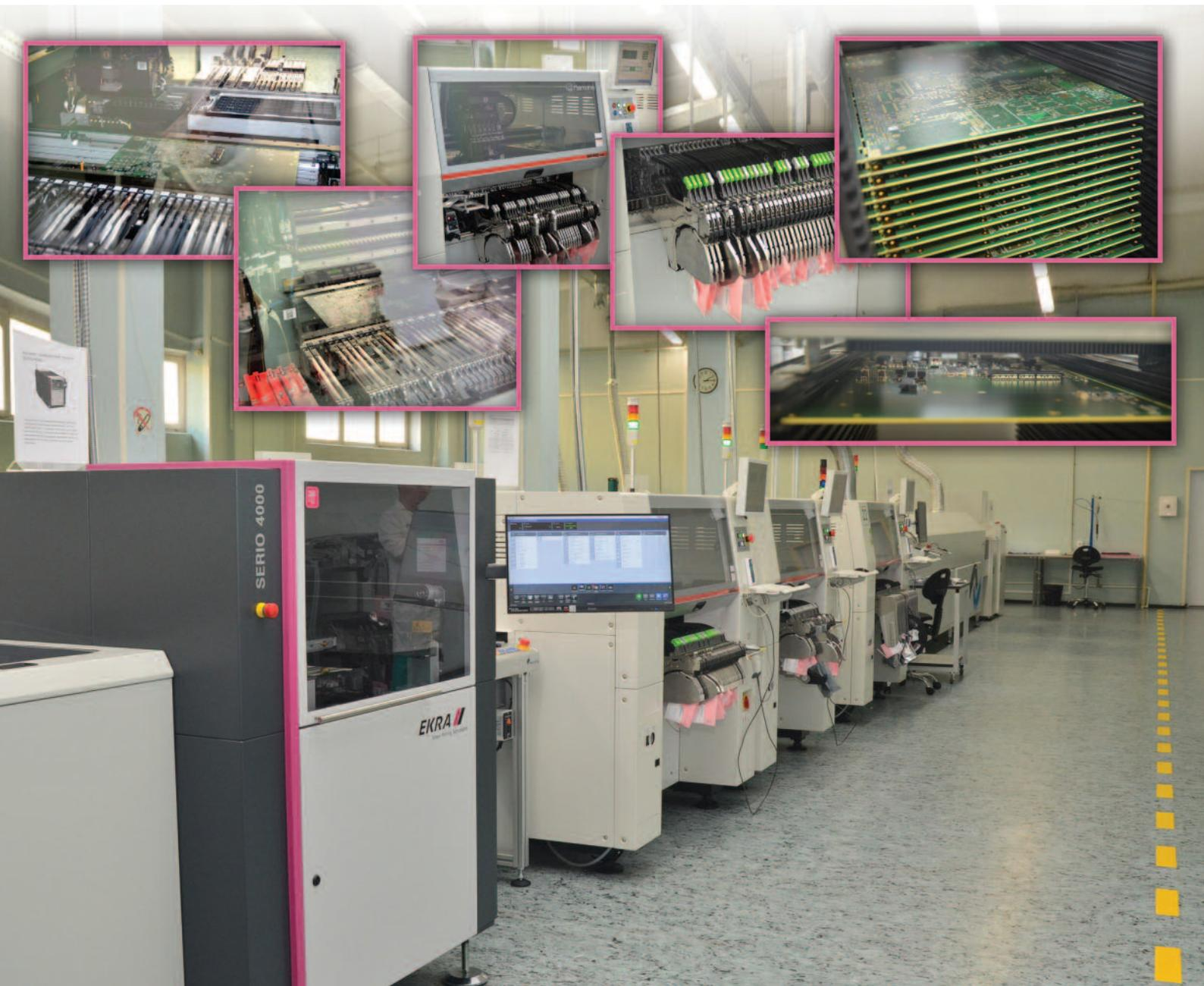
Контрактное производство включает в себя полный набор производственных услуг: поставку печатных плат, комплектацию электронными компонентами, поверхностный монтаж, проверку качества, программирование и тестирование, финальную сборку изделий, серийное производство, хранение и логистику, системную интеграцию.
